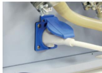
Steckdose zum Anschluss und Steuerung der Vakuumpumpe
