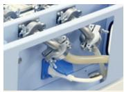
Regulación automática de vacío, incluyendo las dos bridas DIN 16 y tubos de silicona (Ø 8x18 mm)
