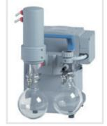
Vacuubrand MZ 2C NT AK+EK (2,0m³/hora, el vacío accesible de 7 mbar)
