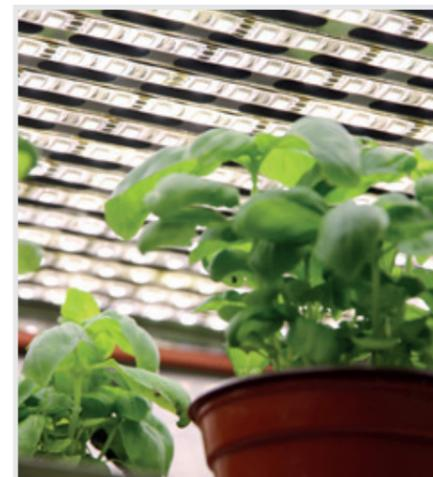
Chambre de croissance précise avec hauteur de croissance variable et éclairage LED à spectre complet pouvant être réglé de manière continue
