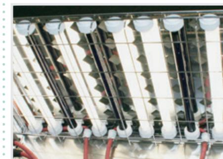
Chambre avec source de lumière VIS-UV combinée ou séparée, avec gestion indépendante et analyse automatique du test de photostabilité
