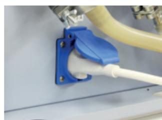
Fiche pour le raccordement et la commande de la pompe à vide
